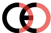
Falsk CE-mærke (for tæt på hinanden)
